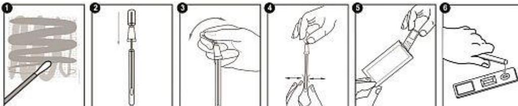
Im Gegensatz zu anderen Sets besteht AllerFlow Gluten aus zwei Bestandteilen - einem Probenaufnahme-Röhrchen und einer Testkassette. Das Röhrchen mit dem Aufnahme-Tupfer enthält bereits die exakt bemessene Menge des Extraktions-Puffers für reproduzierbare Ergebnisse bei minimalem Aufwand. Nach der Probenaufnahme wird die Mulde der Testkassette mit der Flüssigkeit aus dem Röhrchen befüllt. Der Test liefert das Ergebnis innerhalb von 10 Minuten.
